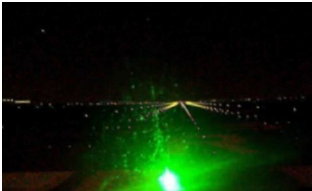
Figura 1. Lumina generată de laser nu obstrucționează luminile pistei, dar este suficient de puternică încât să distragă atenția pilotului. Iradiație: 0.5 \mu\text{W}/\text{cm}^2 ; indicator laser: 5 mW; altitudine: 3 700 ft (1 130 m).
